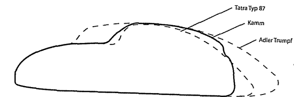
Figura 5.60 – Comparação entre as seções longitudinais dos veículos de Jaray e Kamm. [2]
